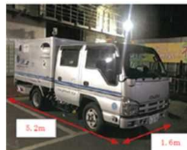
路面下空洞探査車
