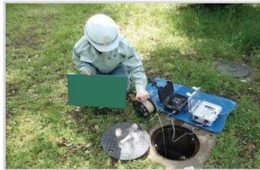
地下水位の観測状況
