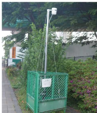
大気質(粉じん等)測定状況
