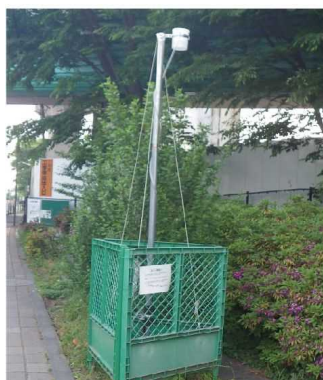
大気質(粉じん等)測定状況
