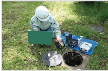
地下水位の観測状況
